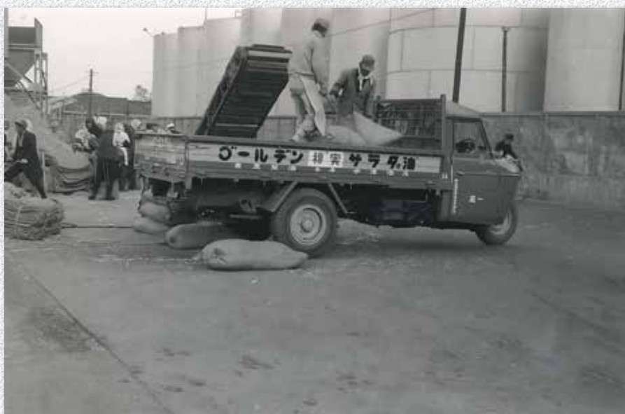
三輪車用パイラーにて積み下ろし
